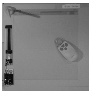
Figure 4.5.a. Tablette graphique WACOM instrumentée par addition de capteurs de force type FSR (force sensing resistor).
