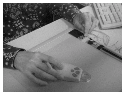
Figure 4.5.b. Simulation d'un vibrato par mouvement du doigt sur tablette instrumentée [VIWR 99].
