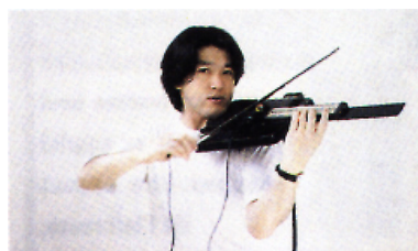
Figure 4.4. SuperPalm, contrôleur MIDI de type violon développé par Suguru Goto (photo), Alain Terrier et Patrice Pierrot [WBD+ 98] [GOT 99].
