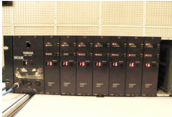
Figure 1. A l'Ircam, un synthétiseur d'origine Yamaha TX 816, dont une grande partie des modules ne fonctionnent plus. Source : Serge Lemouton.
